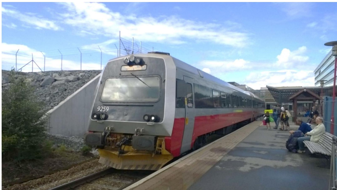
Foto 26 - Automotrice diesel binata gruppo 92 alla fermata dell'aeroporto Værnes, con un servizio da Steinkjer per Trondheim. Sullo sfondo il breve tunnel che passa sotto la pista dell'aeroporto.
